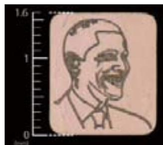
マシニングによる幅30μmの溝加工
